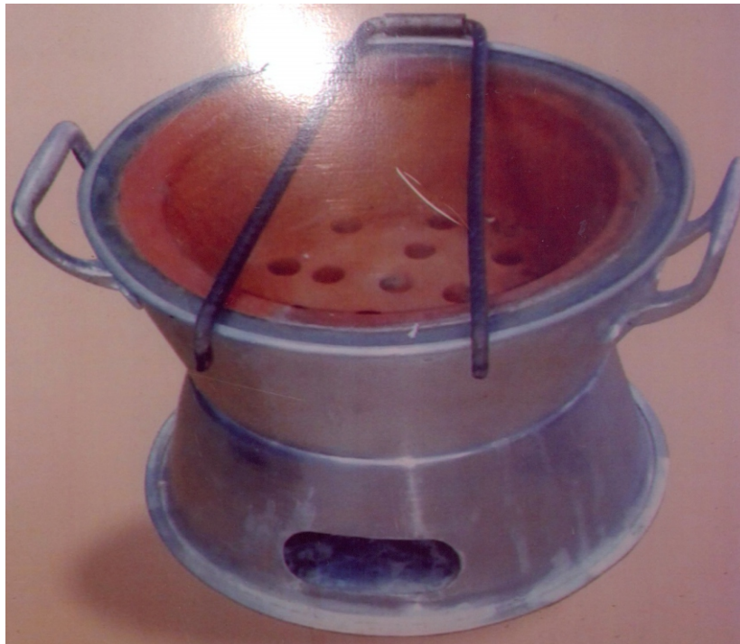
Fogão a Carvão Melhorado Mbaula de Alumínio Autor: Sogepal, Lda
